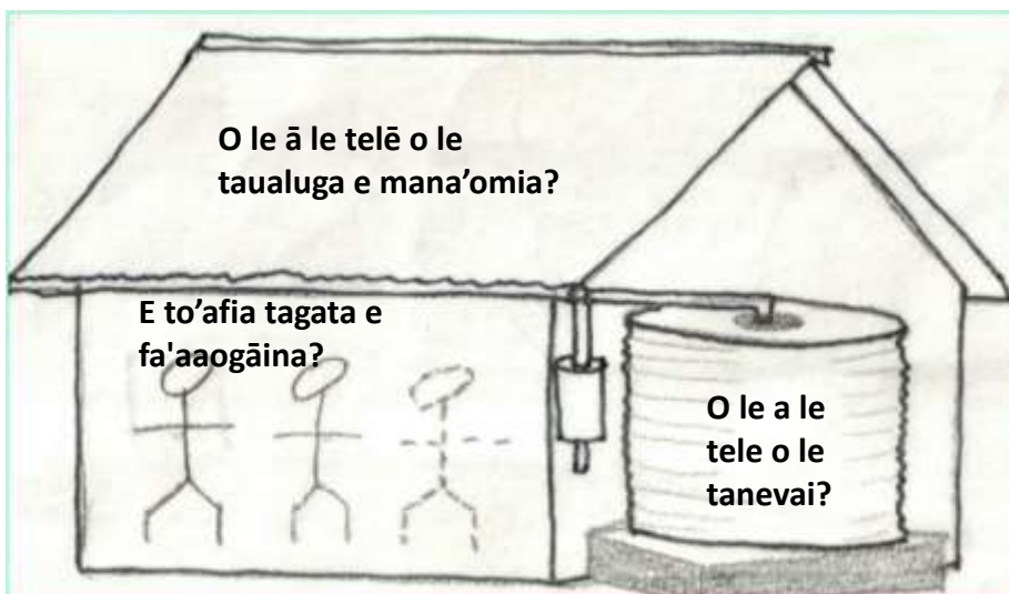
Ata 34: Fa'apāleni le vai mana'omia, telē o le tauluga ma le telē o le tanevai e mautinoa ai le lava o le suāvai i taimi e si'isi'i ai le mago o le 'ele'ele
